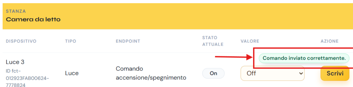
Figura 21: Conferma dell'avvenuto cambio di stato del dispositivo
